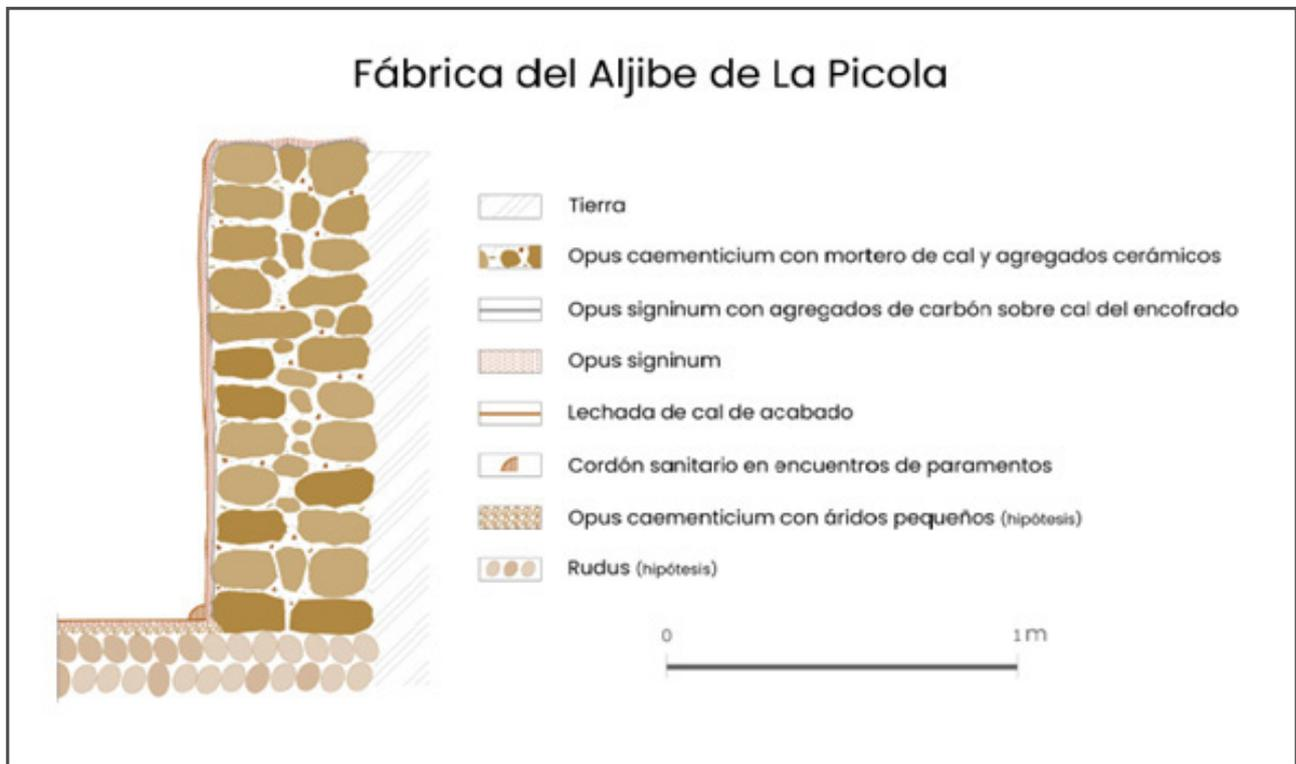
Figura 6.7. Esquema de sección constructiva del aljibe de "La Picola"
